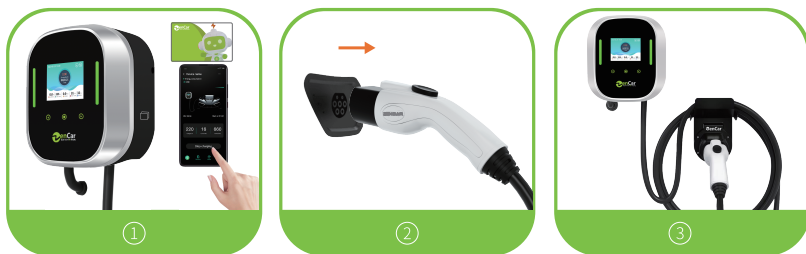
4-2. ábra Töltés leállítása
